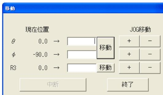
「現在位置」には、 $\theta$ ・ $\phi$ ・R3（照射ユニットの回転軸）の現在の位置が表示されています。入力欄に目的の座標を入力し、「指定座標へ移動」ボタンを押してください。指定した位置へ移動します。中断する場合は「中断ボタン」を押してください。JOG 移動のボタンで操作することも可能です。
