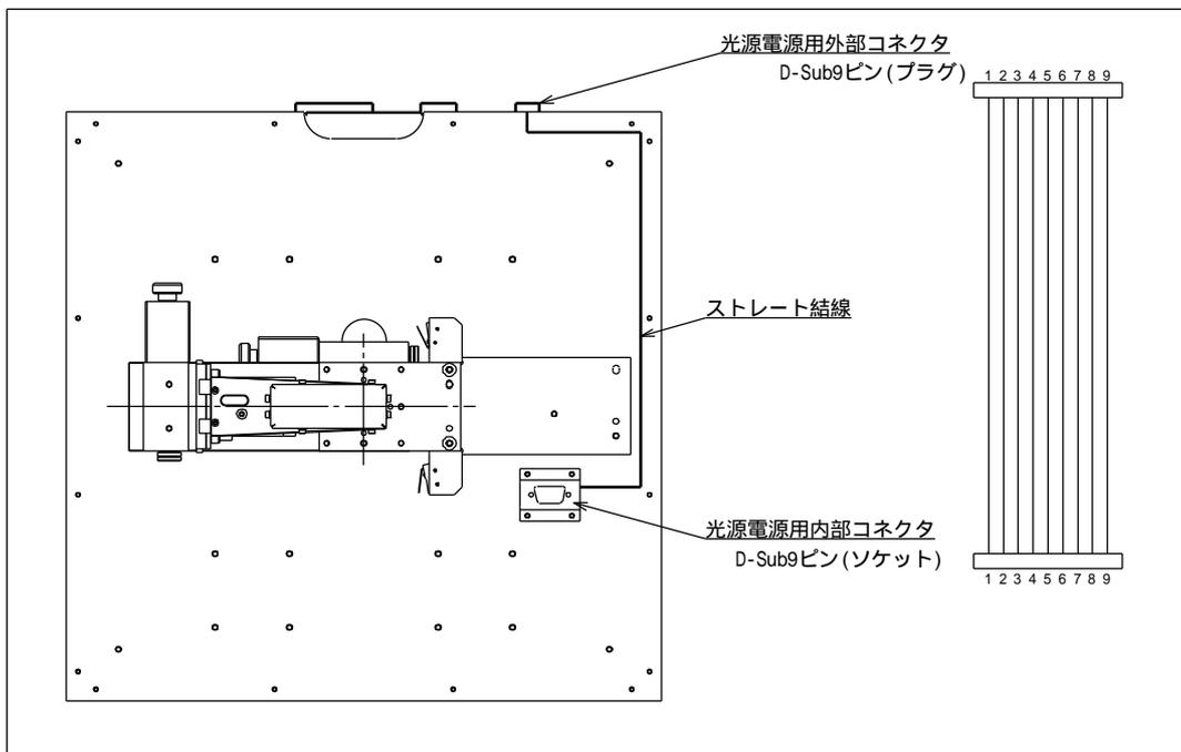
Gonio ユニットの光源電源用内部 / 外部コネクタはストレート結線されています。このため、例えば外部の1,2番ピンに任意の電源をお繋ぎいただければ、そのまま内部の1,2番ピンで電圧が取り出せます。
