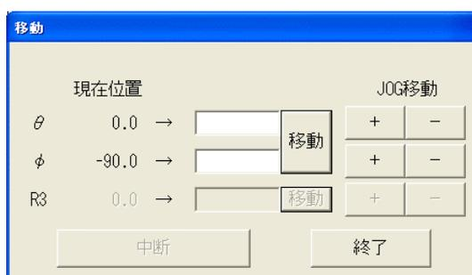
「現在位置」には、 $\theta$  軸の現在の位置が表示されています。入力欄に目的の座標を入力し、「指定座標へ移動」ボタンを押してください。指定した位置へ移動します。中断する場合は「中断ボタン」を押してください。
