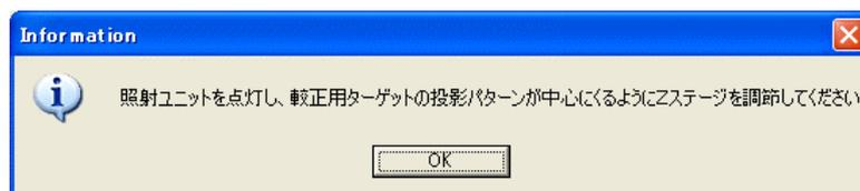
上記のメッセージが表示されたら、照射ユニットを点灯（コントロールユニットの 12V スイッチを ON）して蓋を開けます。散乱試料が既に取り付けてある場合は、その散乱試料を一度取り外し、代わりに高さ調節ターゲットを起きます。Z ステージを調節して、照射光が高さ調節ターゲットの前後方向の中心線にくるようにします。できたら高さ調節ターゲットを取り外し、再度散乱試料を「4-3．散乱試料の取り付け方法」の方法で取り付けます。
